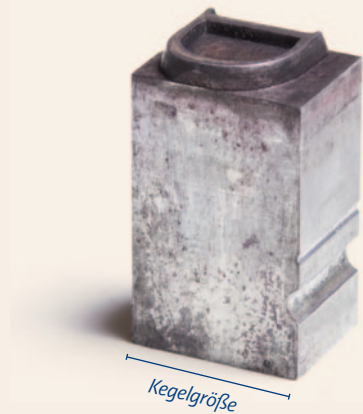
Ein Versal-D als Bleiletter in 36 p / 3 Cicero. Gemessen wurde immer die Kegelhöhe, um die Schriftgröße zu bestimmen. Die Buchstaben selbst waren immer ein bisschen kleiner als die »gemessene« Schriftgröße.
